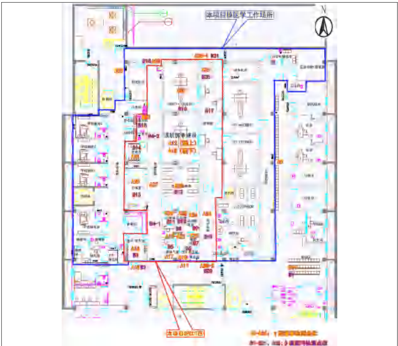
图 6-1 (b) 核医学工作场所内部及周围 X-γ 辐射剂量率监测布点图
