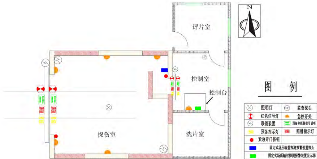
图 3-2 探伤室安全设施布置图
