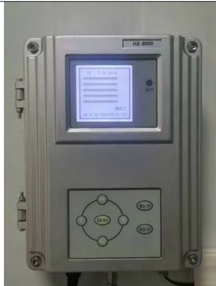
固定式辐射检测仪
