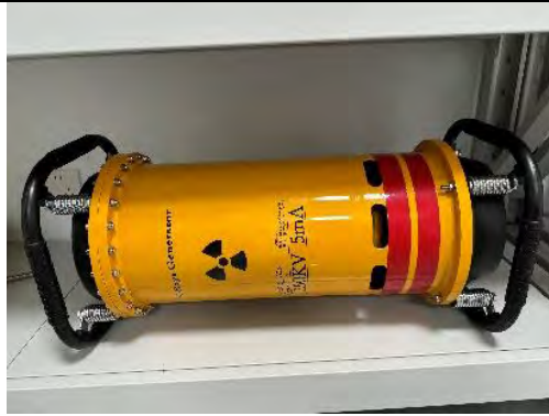
图 2-2 项目 X 射线探伤机现场照片
