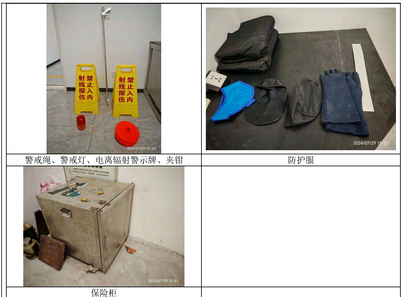
图 3-16 项目防护用品现场照片
