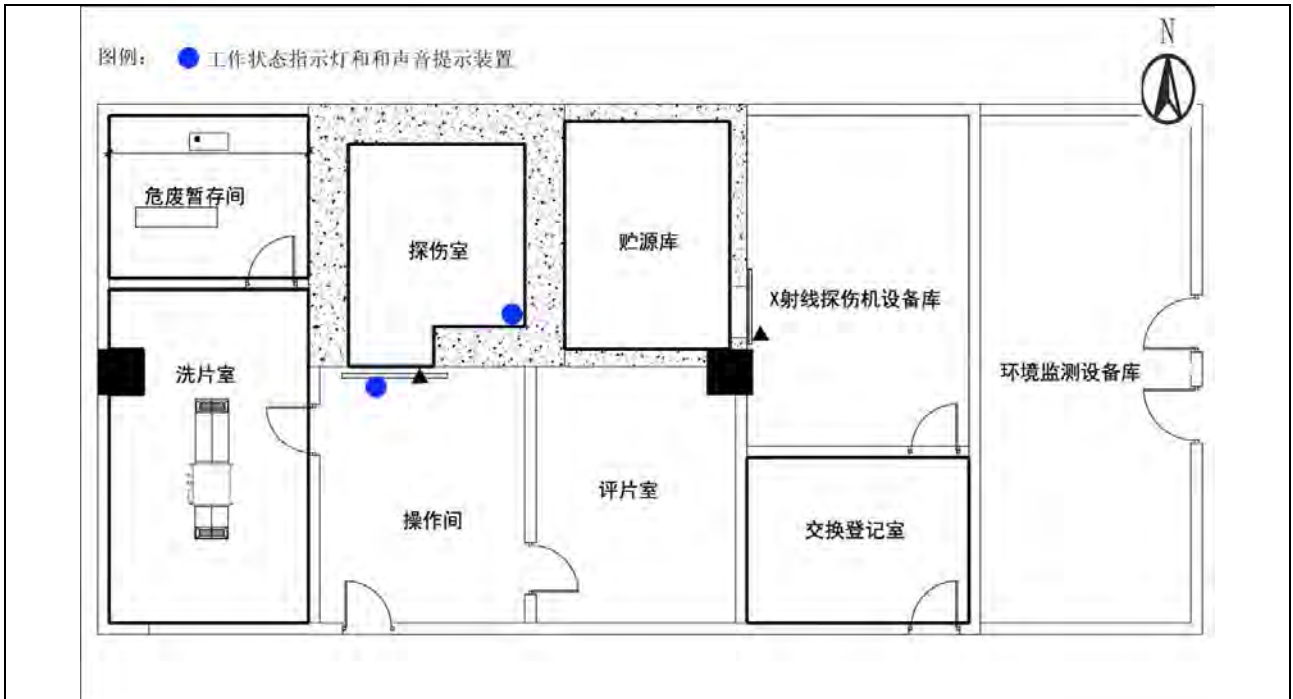
图 3-10 探伤室工作状态指示灯和声音提示装置位置示意图
