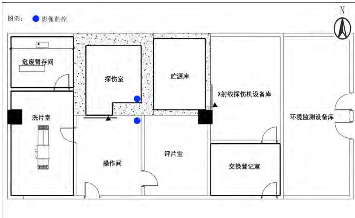
图 3-11 探伤室影像监控装置位置示意图
