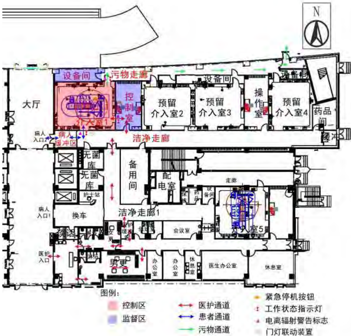
图 3-1 DSA 介入室平面布局图
