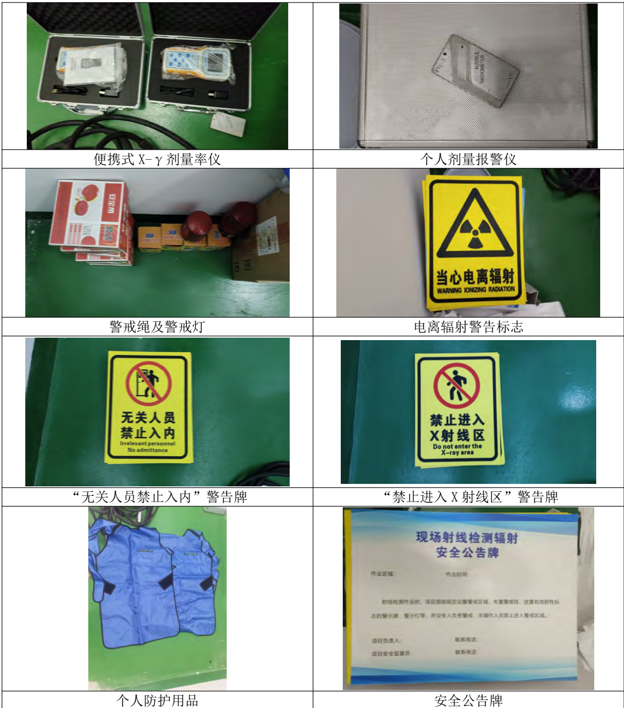
图3-1 本项目主要辐射安全防护设施现场勘查时现状照片
