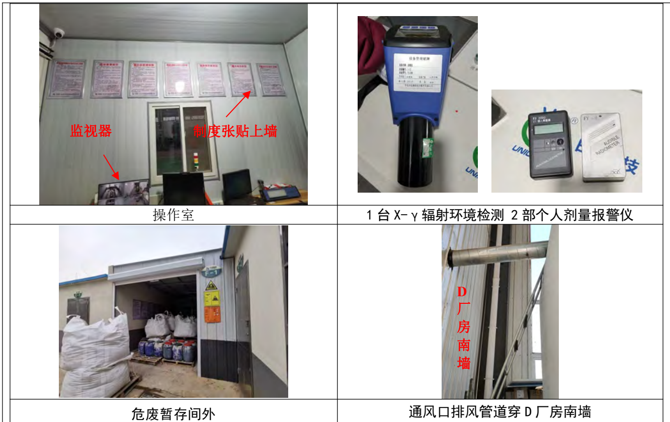
图 4-2 辐射安全与防护情况现场调查现状照片（拍摄于 2022 年 12 月）
